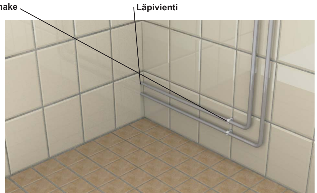
Kaakeli, putkien läpivienti suihkun alapuolelta
